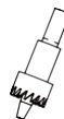
Serras de furo Modo 1: \Phi 24mm Furo inferior (para fase única). Modo 2: \Phi 18mm (Furo traseiro para vedação de borracha)
