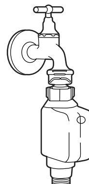
Mangueira de abastecimento de segurança
