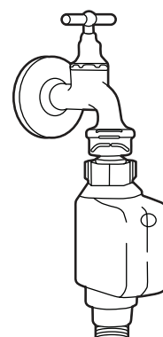
Mangueira de abastecimento de segurança
